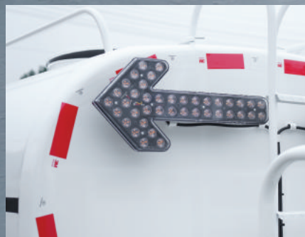
Задний указательный свет Задний указательный свет во время работы автомобиля позволяет лучше предупреждать водителей сзади
