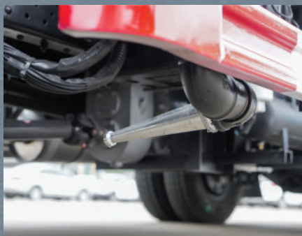
Фронтальный опрыскиватель Фронтальный опрыскиватель может использоваться для омывания дорог и строений
