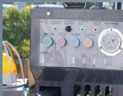
Операционная панель Ясная и понятная операционная панель для удобства использования, с возможностью управления зажиганием, выключением, освещением, системой охлаждения и автоматической позиционированной работой
