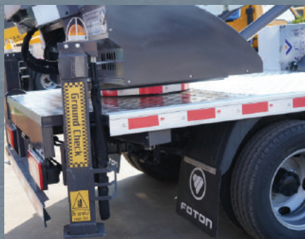
Аутригер Широкий размах, хорошая устойчивость, может работать одновременно или независимо, обладает высокой степенью защиты, долговечен
