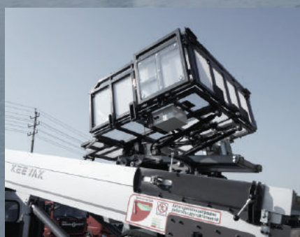
Грузовой ковш Расширяемая, вращающаяся рабочая платформа с высокой грузоподъемностью и надежной стабильностью
