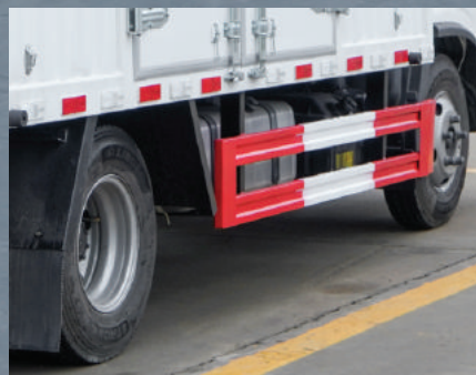
Шины Используются шины 7.00R16LT 8PR для обеспечения хорошего комфорта вождения и плавности движения грузовика
