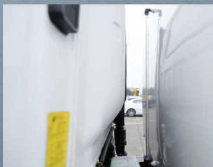
Прозрачные водопроводные трубы Прозрачные водяные трубы могут использоваться для наблюдения уровня воды в баке
